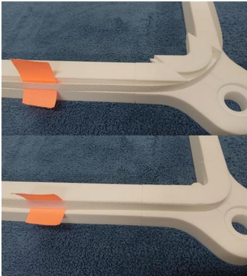
図 9 矩形フレームに 9mm 幅ポリプロピレン製バンドを装着した様子。シートに代えてオレンジ色の紙片を挟んでいる。上：摺動部材は諦着力オフの状態。下：摺動部材は諦着力オンの状態。
