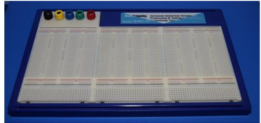
図 5 煩雑な半田ごてによる接続を不要とするブレッドボード。簡便に電子回路を作成することを可能とする。
