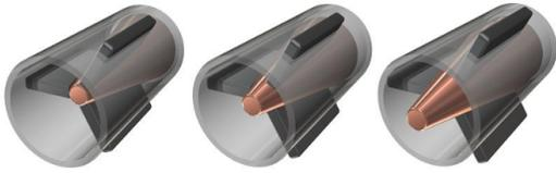
図 12 病室用ベッドの柵用縦孔に本案の装置を使用した場合に、装置全体が回旋することを防ぐための拡張・縮径機構の一案。円錐状の部材が移動することで楔状の部材が3方向に拡張・縮径するように移動する。
