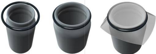
図 5 図 4 における紐を固定長の輪に替えて、壺の直径を拡大しても締着力コントロールが可能となる。
