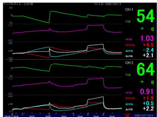
図 3：NIRO-200NX の標準サンプリング時間 (1 秒) における Hb 濃度変化のトレンドグラフ
