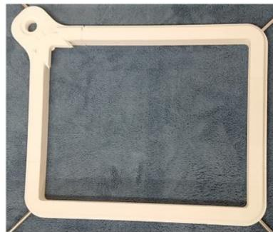
図 8 上：左はスライド部材を締着力オンにした状態。右は締着力オフにした状態。下：スライド部材を 1 コーナーに有する矩形型フレームの 3 D プリント試作。
