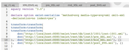
図 3 eXide エディター上での XQuery3.0 言語を用いた XSL transform のパイプライン作成
