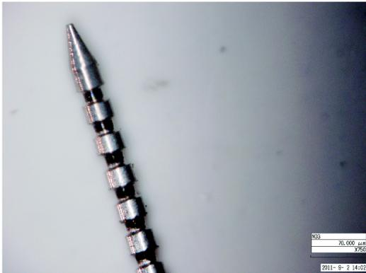
図 8 針表面に溝を付加した“血液吸着型・無痛針”
