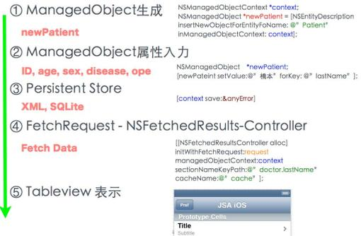
図10 Core Data のプログラムの動作の流れ。
