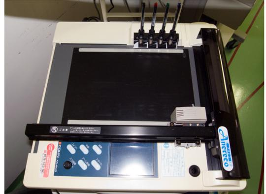
図 1 オムロンコーリン社 ペンプロット式自動麻酔記録装置 Anereco<sup>TM</sup>
