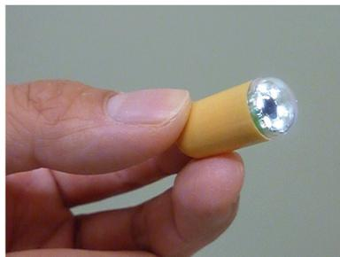
Given Imaging社製 PillCamSBカプセル。長さ26mm、幅11mm。1秒間に2枚の画像撮影を約8時間行うことができる。現在は、第2世代のPillCamSB2に更新されている。
