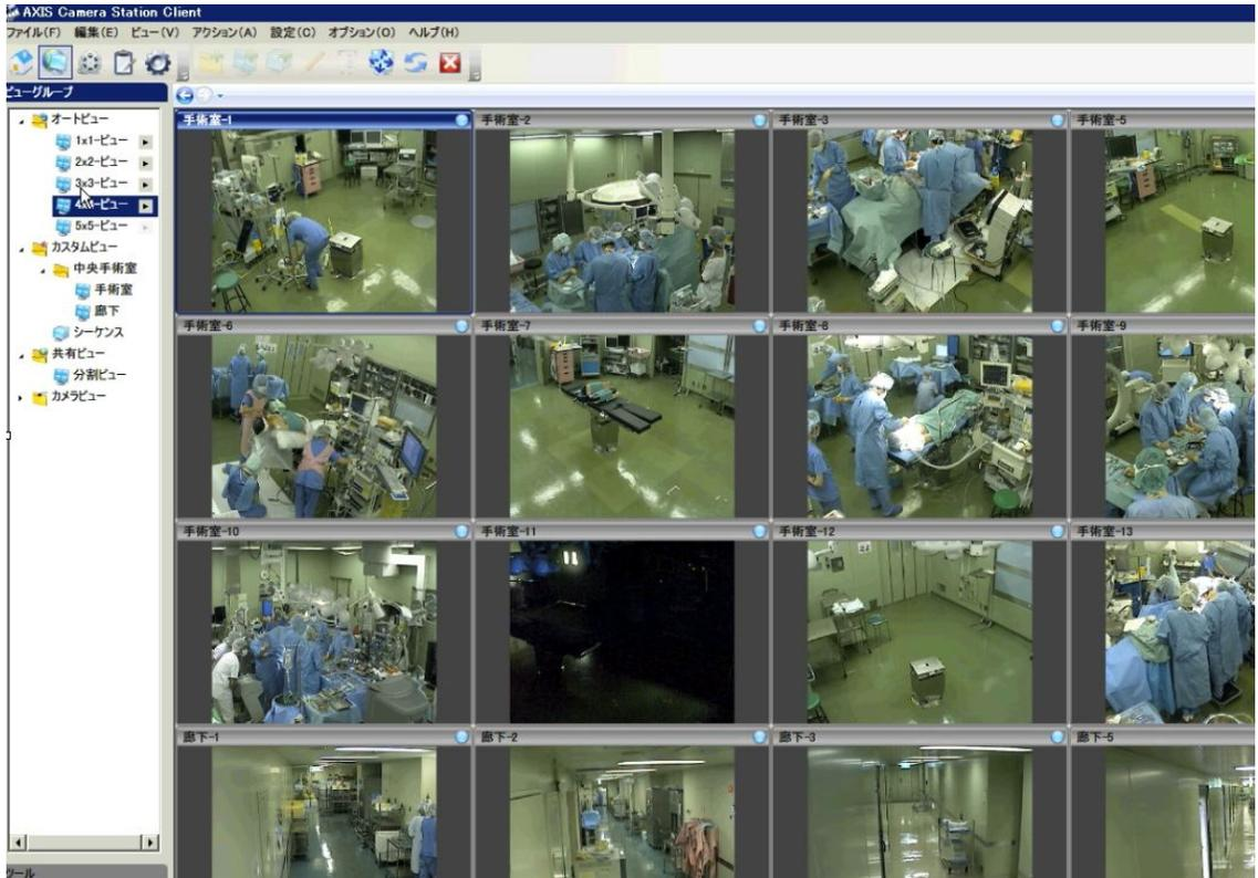
図 4 AXIS の専用画像供覧ソフトにより最大 25 画面の同時視聴が可能となる。同時に録画再生なども簡便に行うことができる。
