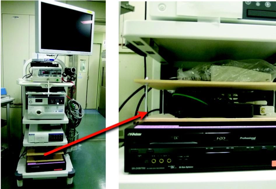
図 6 内視鏡装置架台下部に設置された DVD レコーダーの上に、エンコーダ及び無線子機などをまとめて設置した。内視鏡装置の本体スイッチを入れるだけで無線通信が確立する。
