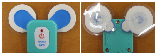
図3 RF-ECG (電極装着) 左：表側 右：裏側
