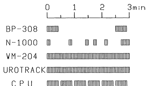
図4 心電血圧計は2.5分単位でデータ転送を行い、呼吸経皮酸素濃度モニターは不定期な時間、尿量計および体重計は1秒毎にデータ転送されている。
