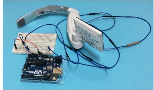
図2 McGRATH™, 感圧センサー, Arduino™ Uno Rev3 を用いた機器
