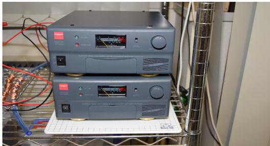
図4 実験に用いた安定化電源装置．1つで40アンペアの電流を供給することができる．GZV4000 (第一電波工業 ダイヤモンド スイッチングモード 直流安定化電源 連続 40A)
